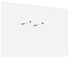
Percez un trou à travers les marques avec le foret de 1/4 po. Puis, insérez les ancrages pour cloison sèche dans les trous et cognez sur celles-ci avec le maillet pour les enfoncer à égalité avec le mur.
