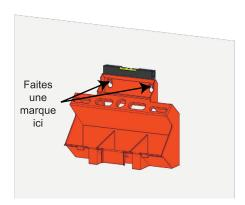
À l'aide d'un niveau, tenez le Vertical Organizer à l'emplacement désiré sur le mur, puis faites une marque à l'intérieur des trous de montage avec un marqueur ou un crayon et enlevez le Vertical Organizer du mur.
