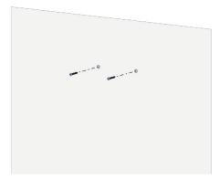
Vissez les vis dans les ancrages à l'aide d'un tournevis cruciforme. Laissez les vis sorties d'environ 1/4 po du mur.
