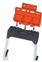
Pour fixer sur le capuchon supérieur des échelles Quick-N-Lite™, Xtra-Lite™ et MightyLite™, situez les languettes à l'avant du Vertical Organizer et alignez-les avec les trous dans le capuchon supérieur.
